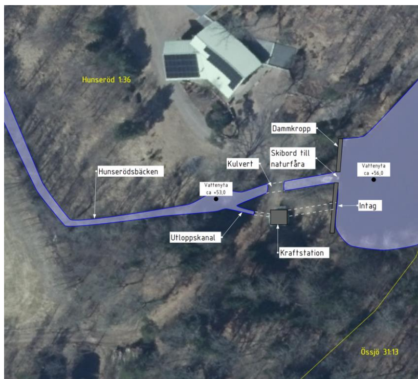
Figur 3. Dammkropp och kraftstation. Nivåer avser RH2000.
