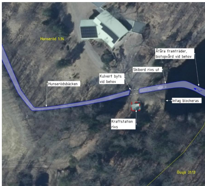
Figur 11. Planerade åtgärder i anslutning till dammkroppen.
