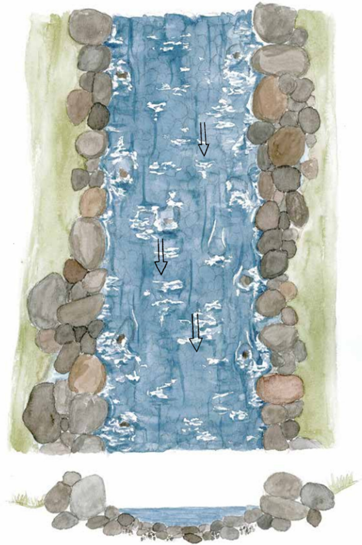
Figur 1. Illustration utav en kanaliserad sträcka före åtgärd.
