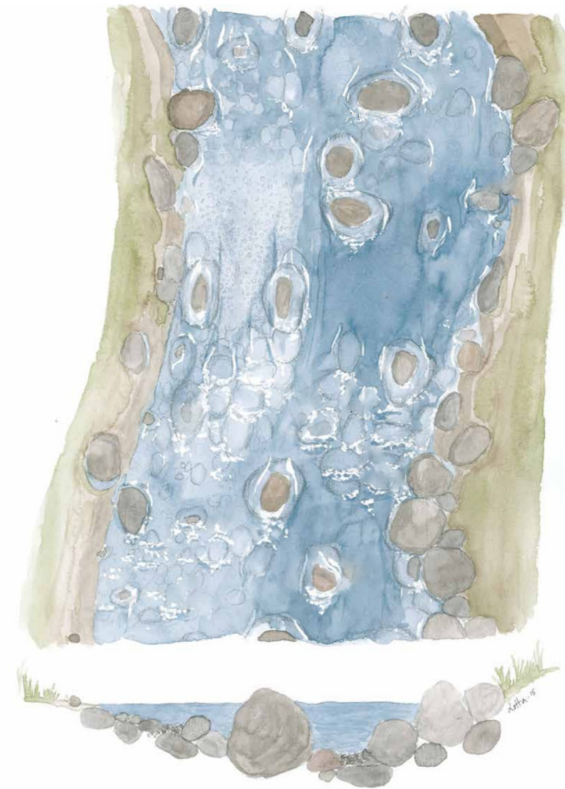
Figur 2. Illustration utav en kanaliserad sträcka efter åtgärd.
